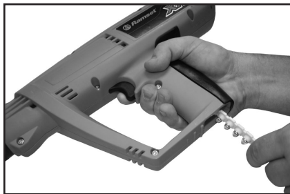
2. INSERTE LA CARGA DE PÓLVORA
